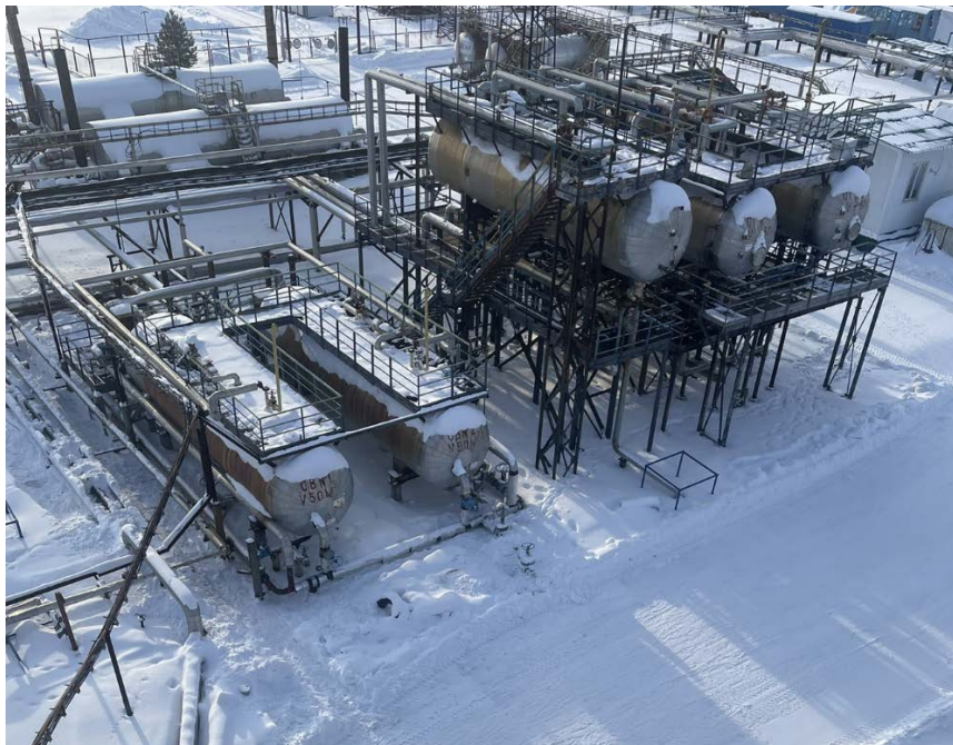
11.2-11.3 Отстойник воды ОВ-1,2
