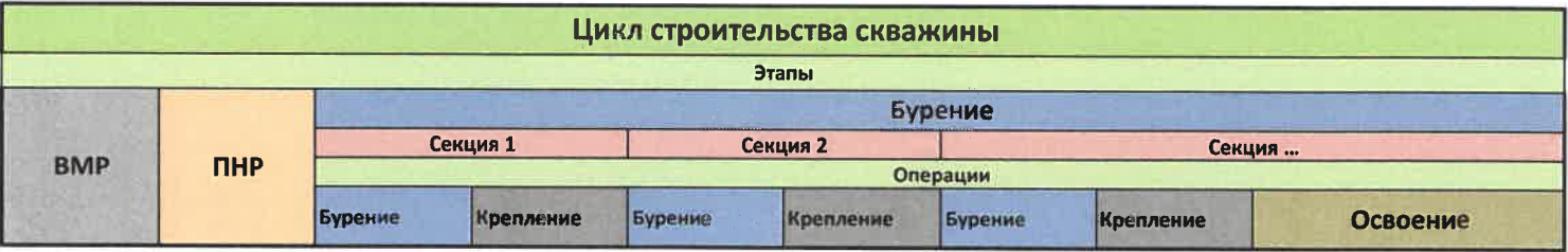
Блок-схема цикла восстановления скважины методом ЗБС / реконструкции скважины
