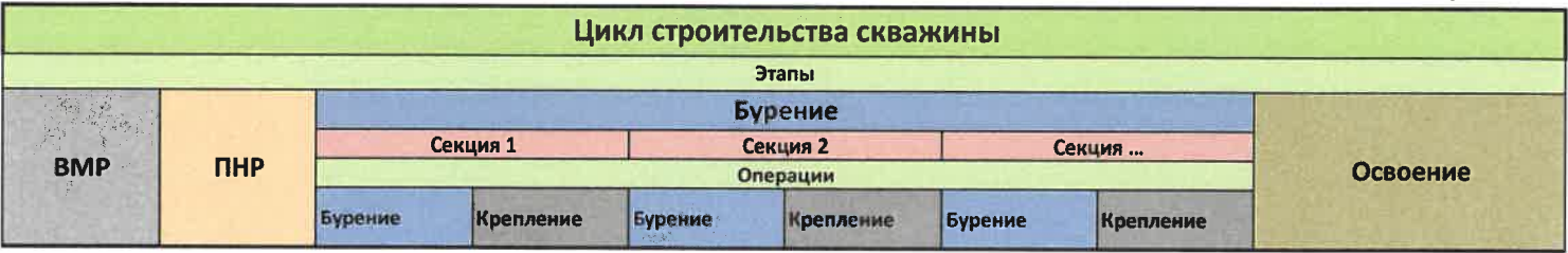
Блок-схема цикла строительства скважины при геологоразведочном бурении
