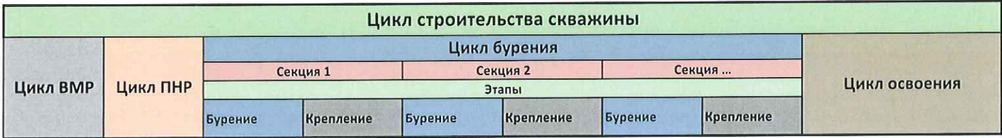
Блок-схема цикла строительства скважины при геологоразведочном бурении
