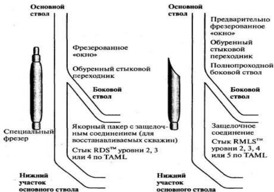
Рис. 2 Техничко-технологические схемы по проводке стволов и ответвлений
