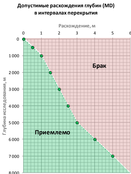
Рис. 7 Пределы допустимых расхождений замеров глубины по стволу
