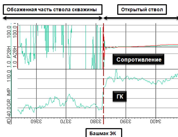
Рис. 8 Пример записи каротажей после выхода из ЭК
