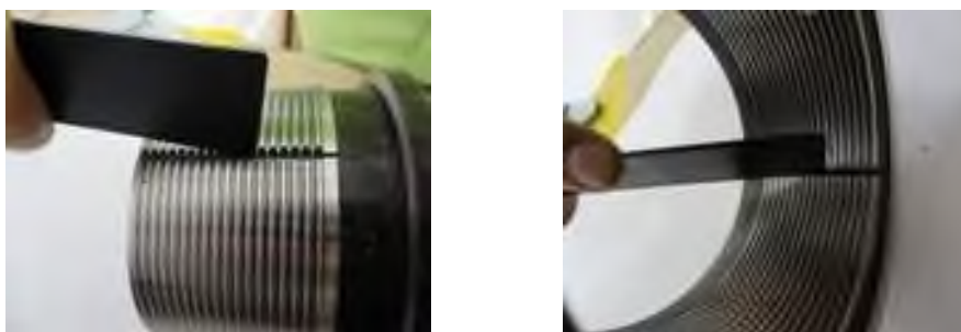
Рис. 1 Рекомендации по очистке резьбовых калибров перед применением
