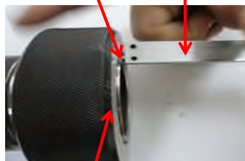
Измерительная плоскость гладкого калибра кольца
