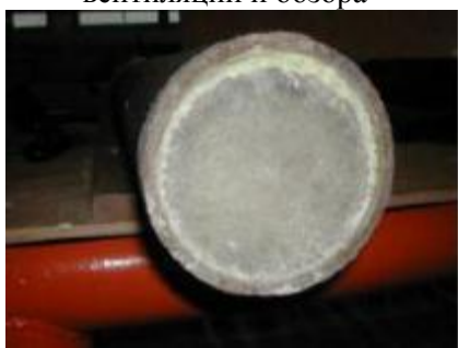
Пена удалена с обоих концов. Видно, как пена создала изоляционный слой вокруг керна
