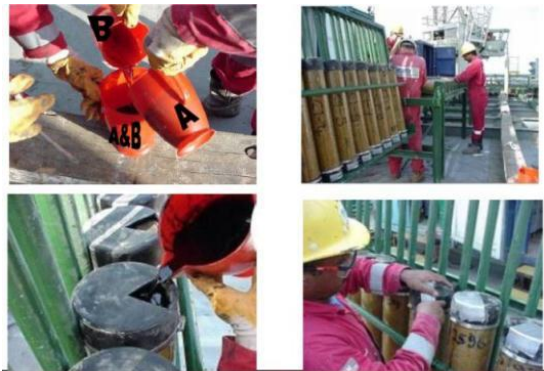
Рис. 35 Стабилизация керна смолой
