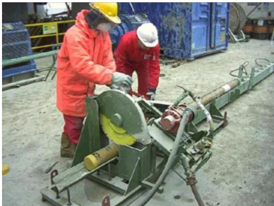
Рис. 32 Система распиловки керноприёмной трубы на секции
