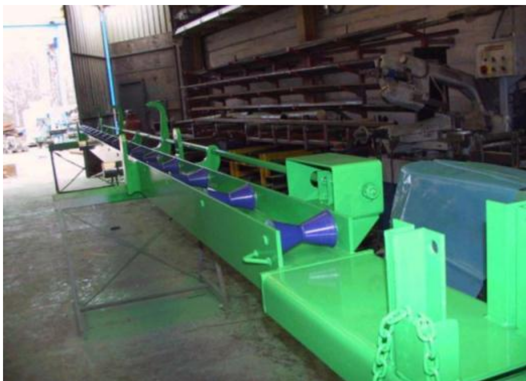
Рис. 18 Укладочная рама со специальным дистанционным замковым соединением
