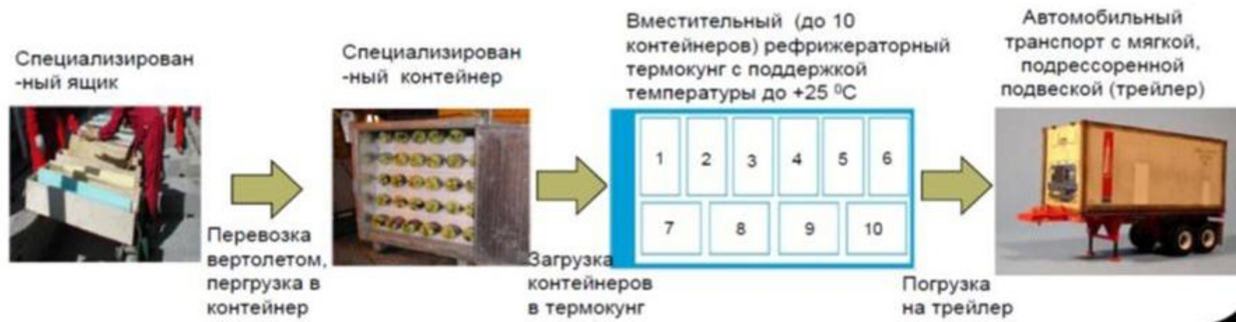
Рис. 7 Типовые схемы транспортировки неконсолидированного керна
