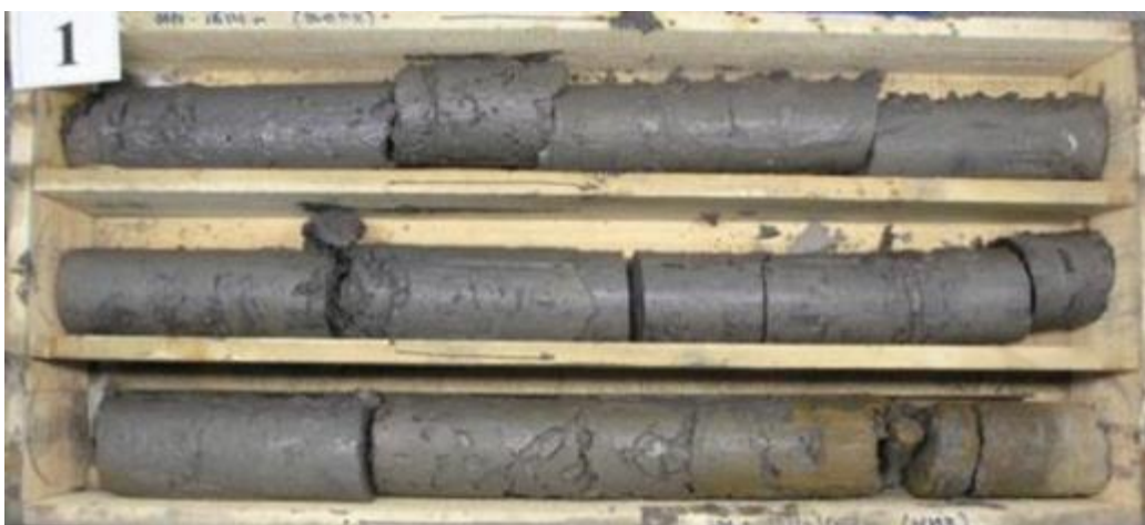
Рис. 2 Пример керна, отобранного с нарушениями технологии отбора по изолированной технологии (толстая глинистая корка)
