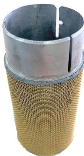
Рис. 4. Вращающийся цилиндр со втулкой из сетки
