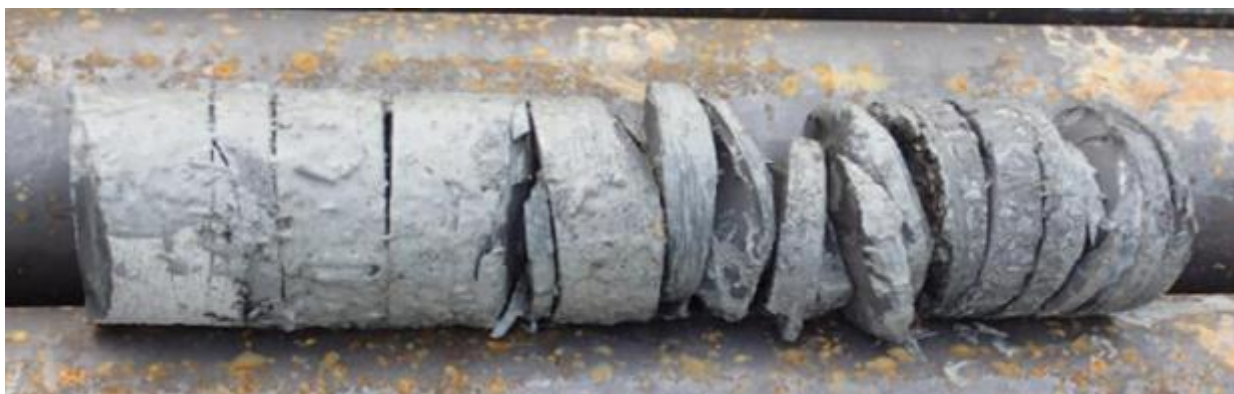
Рис. 21 Керн, растрескавшийся в результате прогибания и изгибания внутренней трубы керноотборника
