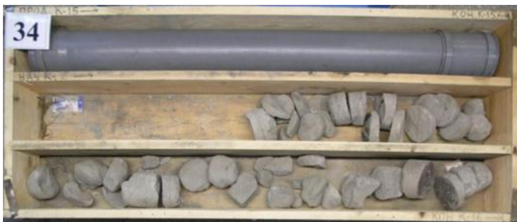
Рис. 4 Пример керна, отобранного с нарушениями технологии отбора по обычной технологии (уменьшение диаметра керна, большая сегментация)
