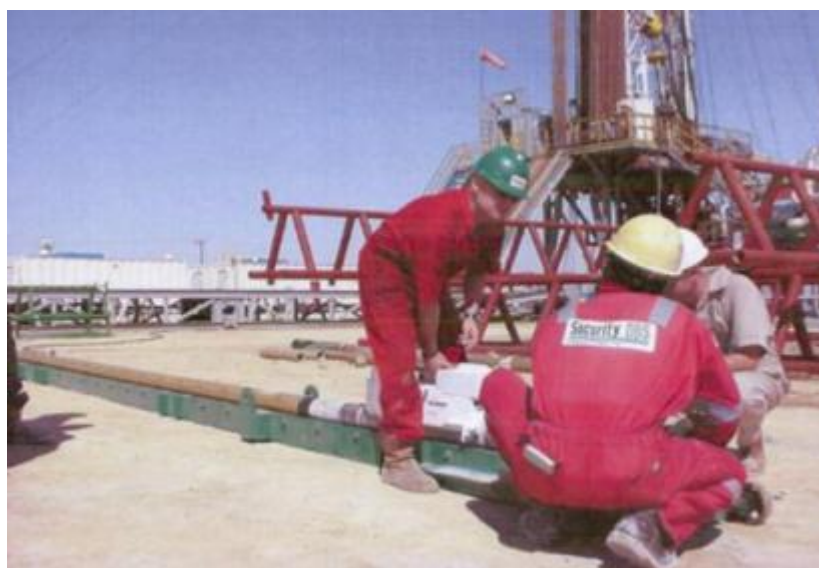
Рис. 27 Регистрация естественного гамма-излучения керна
