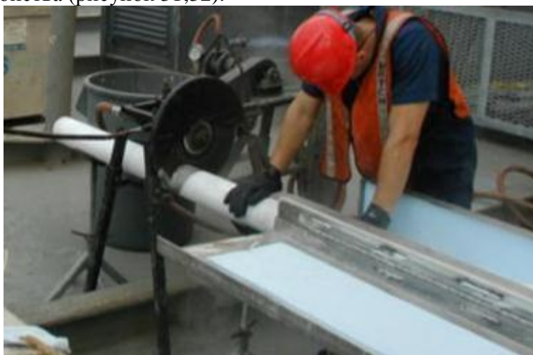
Рис. 31 Система распиловки керноприёмной трубы на секции
