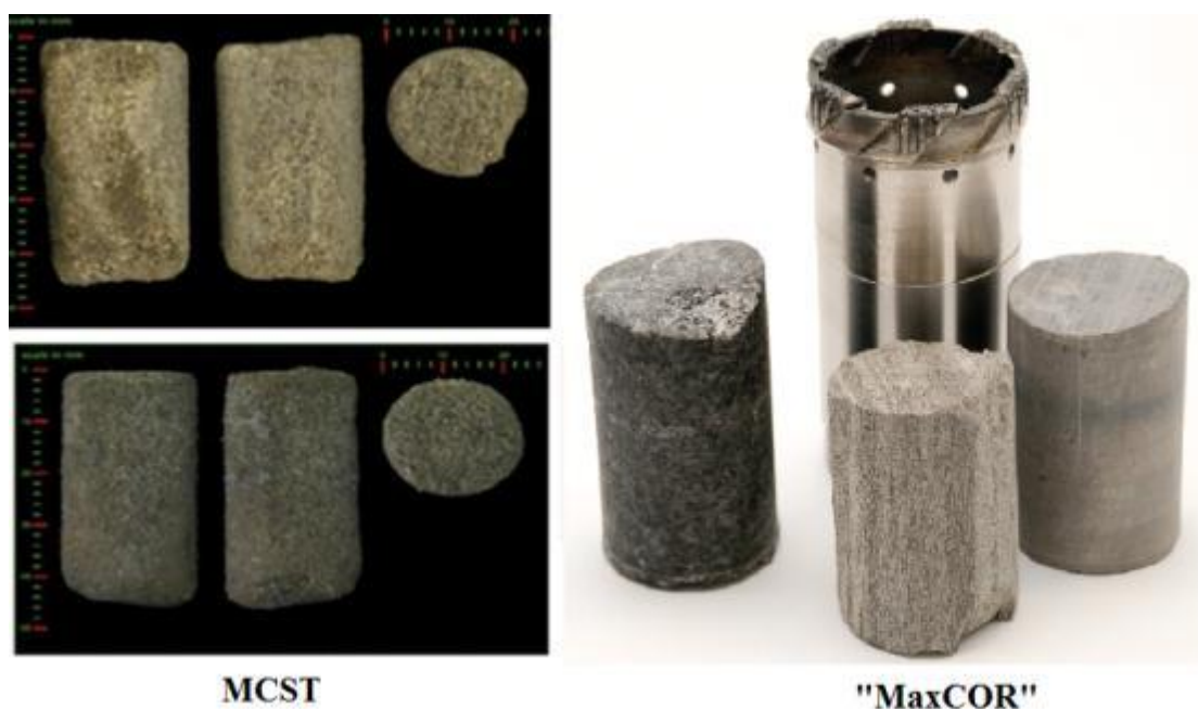
Рис. 14 Образцы керна выбуренные системами MCST (диаметр образца 1 дюйм) и MaxCOR (диаметр образца 1,5 дюйма)
