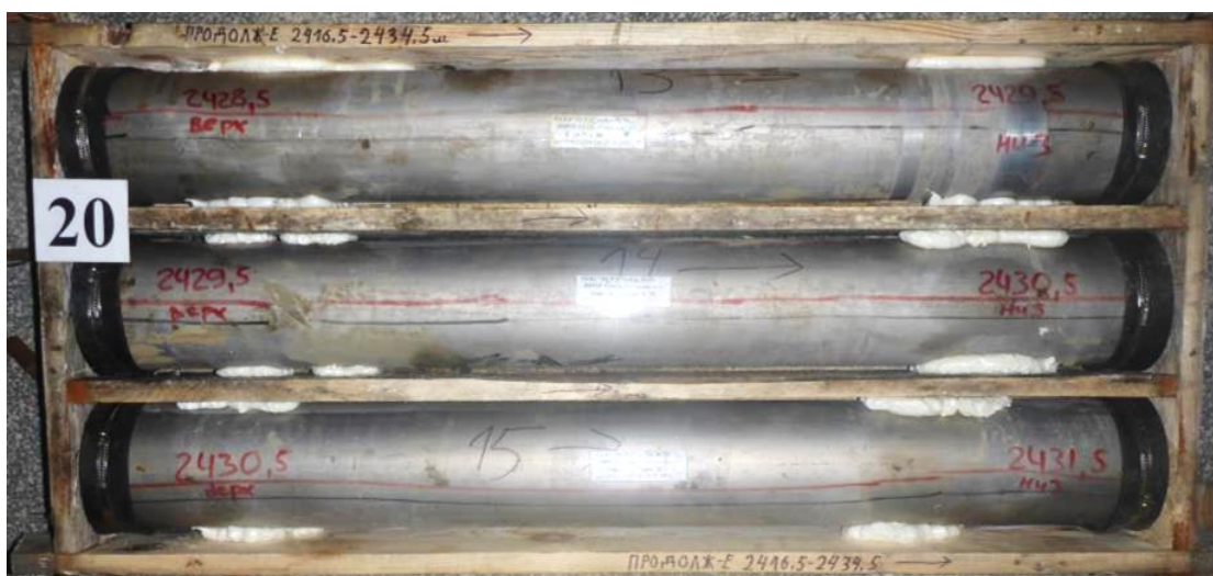
Рис. 42 Пример корректной укладки керна в ящик
