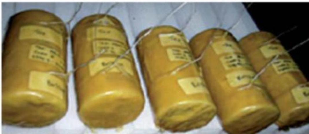
Рис. 41 Консервирование керна воском
