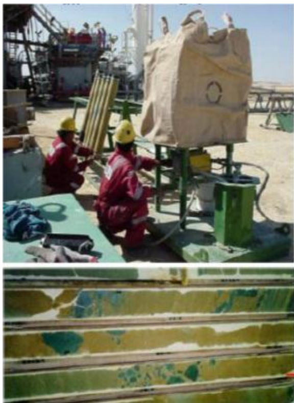
Рис. 33 Стабилизация керна гипсом
