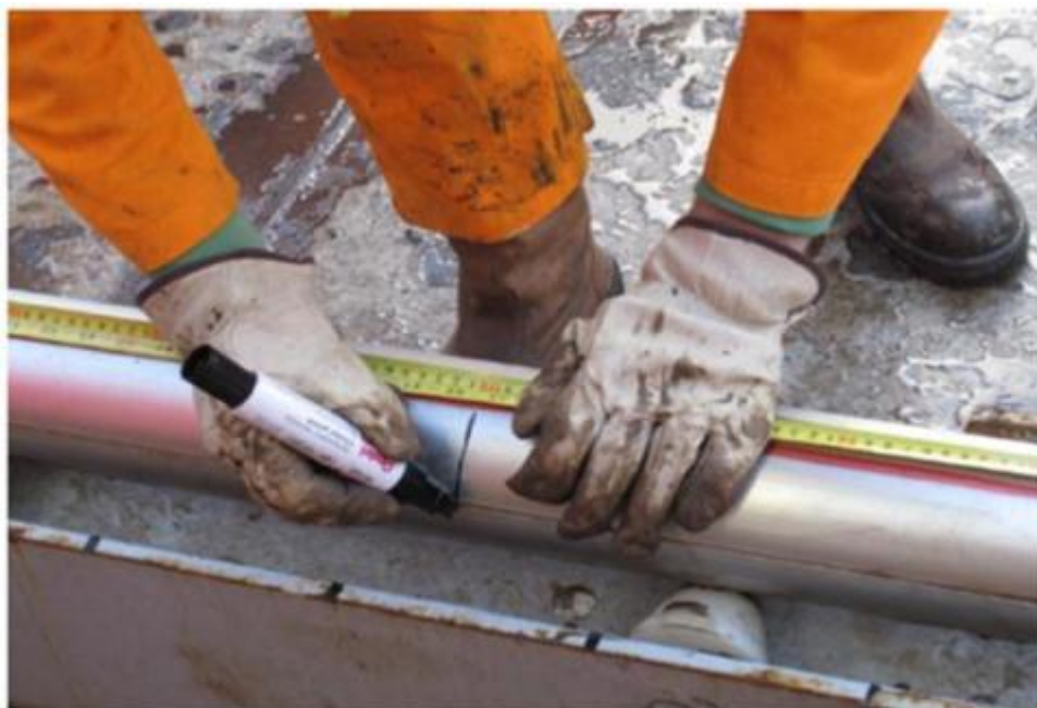
Рис. 23 Пример разметки двумя контрастными цветными линиями и деления на метровые тубусы
