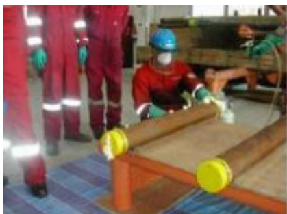
Пена увеличивается в объеме и выходит из отверстий для вентиляции и обзора
