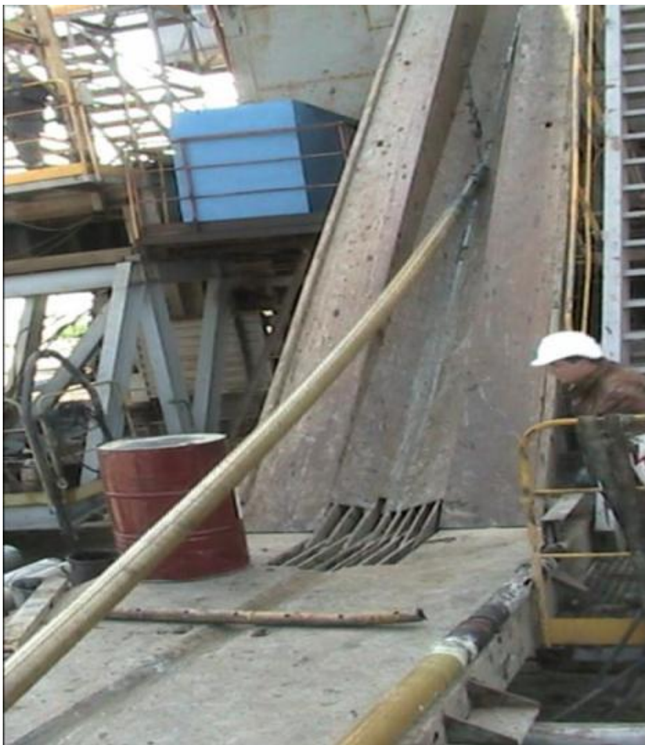
Рис. 20 Спуск тубуса из стеклопластика, с керном без устройства, исключающего прогиб
