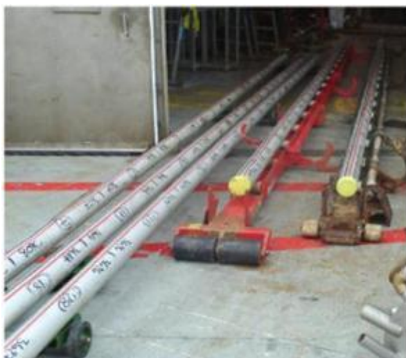
Рис. 24 Примеры корректной разметки и маркировки керноприёмной трубы перед распиловкой
