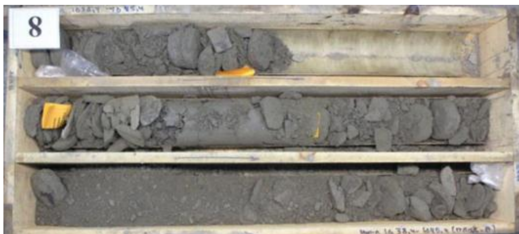
Рис. 3 Пример керна, отобранного с нарушениями технологии отбора по изолированной технологии (раздробленный керн)
