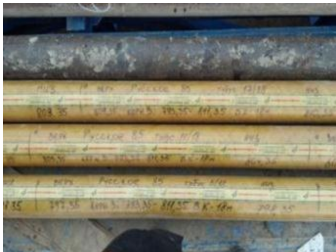
Рис. 24 Примеры корректной разметки и маркировки керноприёмной трубы перед распиловкой
