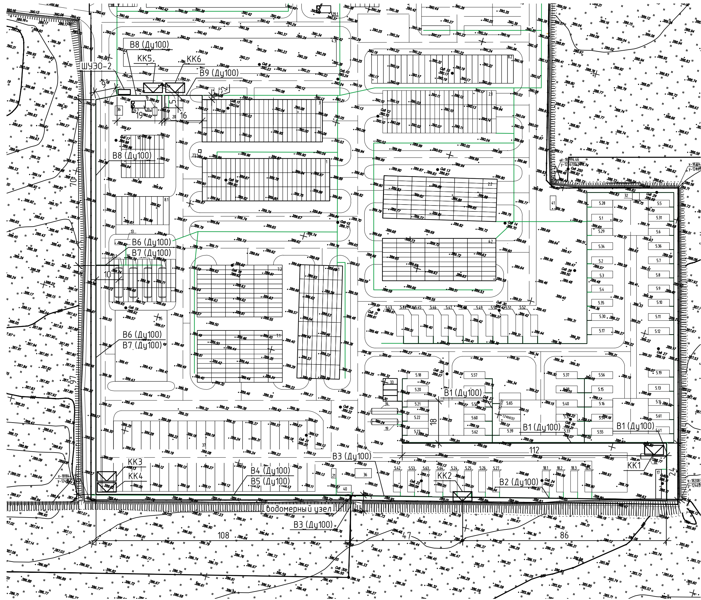
План электрообогрева труб водоснабжения В7 (исходная вода)
